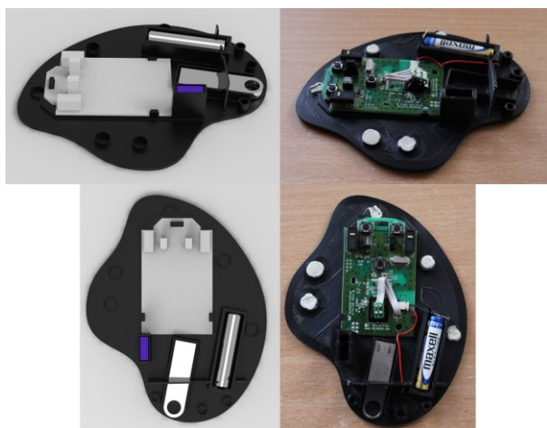
Fig. 1 Bază prototip – randare 3D vs. componentă fabricată
