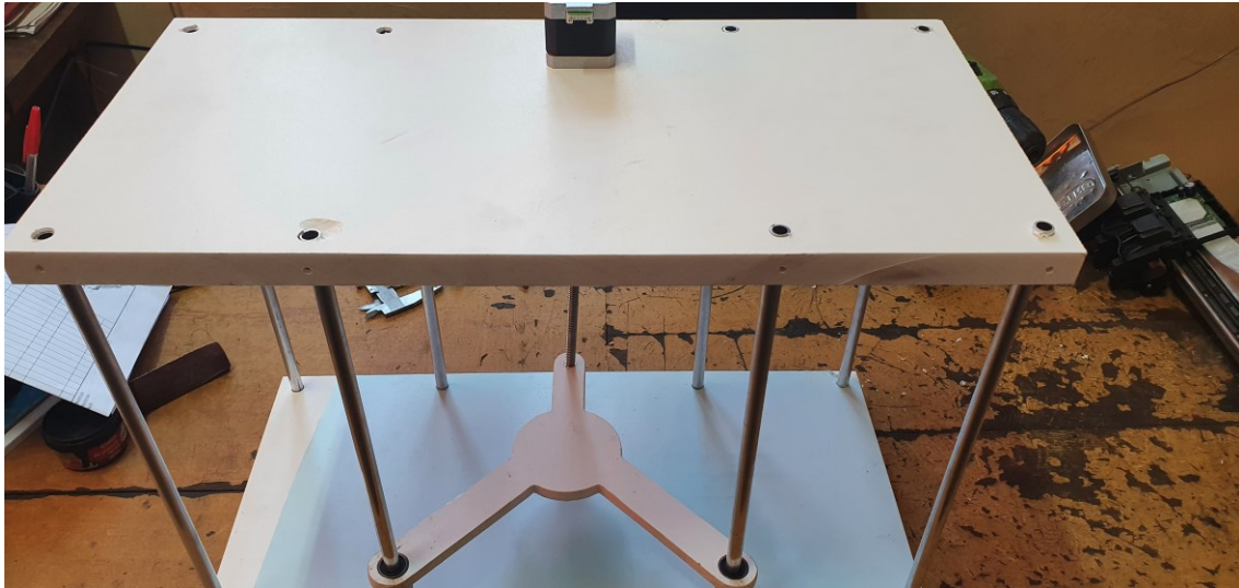
Fig.5 Asamblarea placa superioara pe cadrul imprimantei
