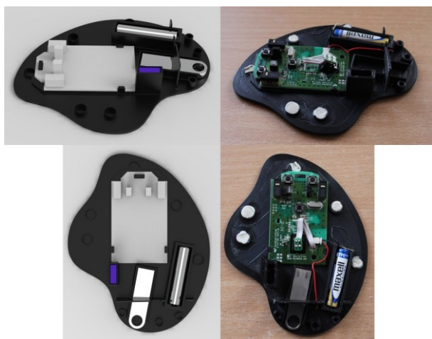
Fig. 1 Bază prototip – randare 3D vs. componentă fabricată
