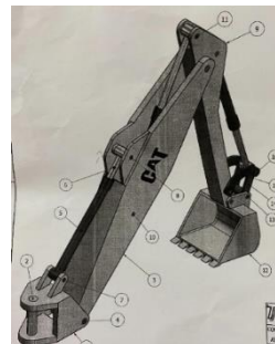
Figura.2. Partea mobilă a excavatorului
