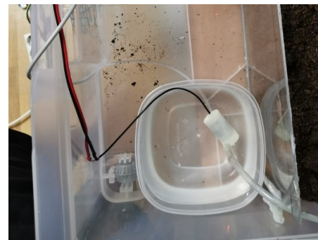
Fig.12. Montarea pompei de apa
