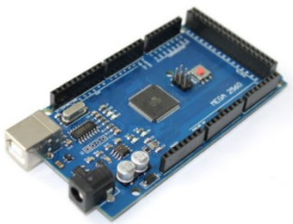
Fig.2 Placa de dezvoltare
