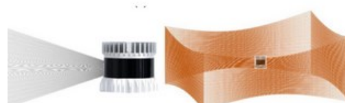
Fig. 2. Model grafic de citire LIDAR 3D la 360°
