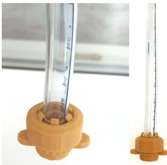
Fig.4.3.3 Elementele conectorului printate 3D împreună cu tubul endotraheal
