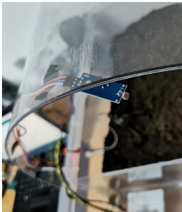
Fig.10. Montarea senzorului de lumina-intensitate luminoasa
