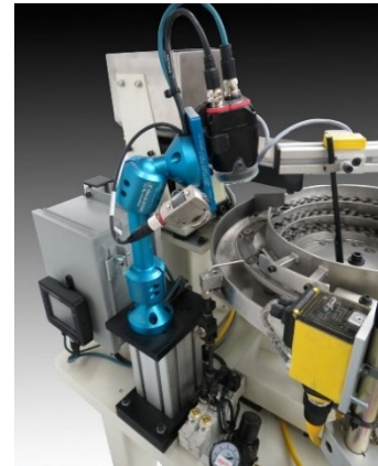
Fig. 4. Sistem optic pentru recunoașterea orientării pieselor [7]
