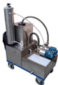
Fig. 4. Dispozitiv pentru filtrare la găurirea EDM al companiei ELERO [3]
