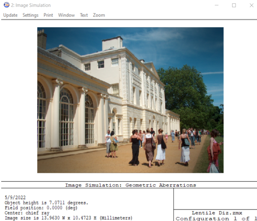
Fig 2.6.– Simulation d'une image observée avec l'objectif
