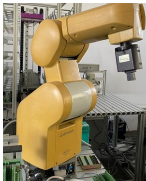
Fig. 2. RV-E3 industrial robot
